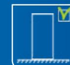
Le réfrigérateur doit être de niveau (max < 2,5°)
