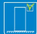
Le réfrigérateur doit être de niveau (max < 3°)
